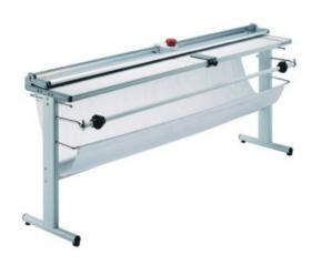
Cizallas de planos de cuchilla de corte giratoria. Particularmente fuerte para cortar materiales más gruesos, montado en una barra rectangular deslizante. Superficie de trabajo en chapa de acero pintado con resina epoxy en polvo, con rejilla de serigrafía para facilitar el corte en diferentes formatos con un cuadrado de referencia.
